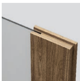
spojenie so sklom „na hranu“ polodrážkové krídlo
